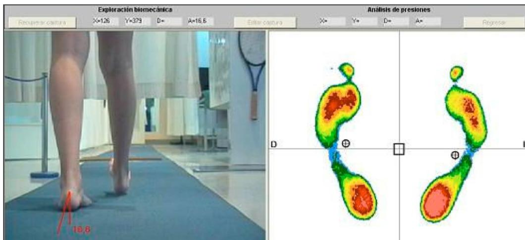
El nuevo sistema de exploración consta de una Banco de Marcha informatizado que comprende una plataforma sensora de presiones que incorpora a su vez el Sistema BaroPodoNeumático de captación.
